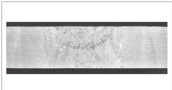
UOE钢管腐蚀试验后的宏观端面
